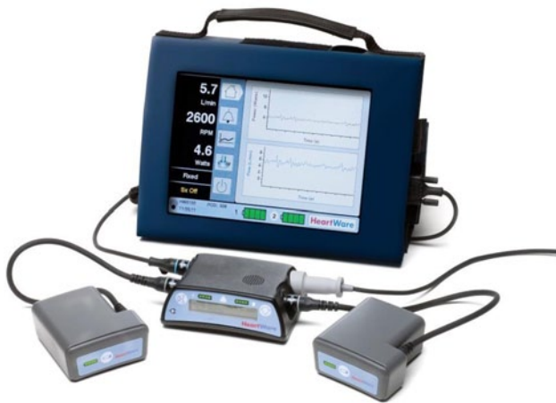
Abb. 5 Controller, Monitor und Akkumulatoren des HeartWare®-Systems [34]
